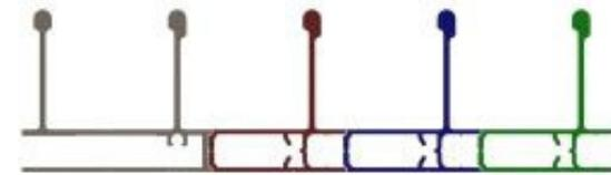
El diseño especial de perfilería inferior de SlideMaster permite la posibilidad de una instalación con riel infinito. Esto nos da la posibilidad de una instalación con un número ilimitado de paneles y con una superficie de cerramiento totalmente adaptable a las necesidades.
