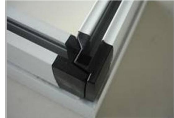
El diseño de tapas nos permite realizar una unión perfecta entre perfiles de hoja al igual que la formación de esquinas perfectas. Además disponemos de sistema de felpudos entre perfiles, marcos laterales. Las juntas en H para unión entre cristales y el h para la primera hoja de apertura confieren mayor estanqueidad y resistencia al aire
