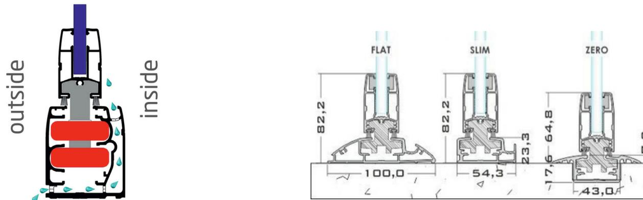
El sistema Tiara dispone de un sistema de drenaje de agua oculto integrado bajo el riel del perfil inferior. Este perfil permite al sistema liberar el agua formada sobre los paneles por efecto de la condensación a través del carril inferior hacia el exterior del cerramiento.
