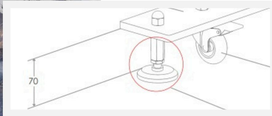
Airflex se puede instalar fijándolo en el suelo, o sobre una base con ruedas para ser fácilmente transportado.
